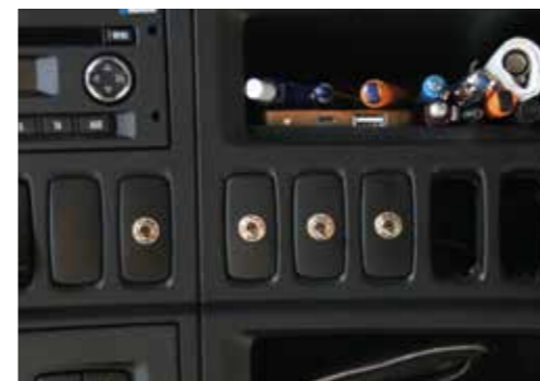
Kippschalter für die Zu- und Abschaltung der einzelnen Kameras.
