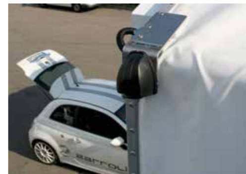
Seitenkamera mit Spezialhalterung für den Planaufbau.
